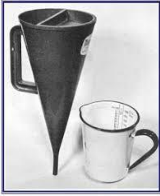
Şərti özlülüyü ölçən MARŞ qığı Воронка МАРША для вязкости раствора MARCH funnel for solution viscosity
